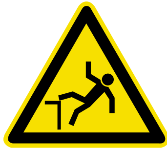
W15 Warnung vor Absturzgefahr
