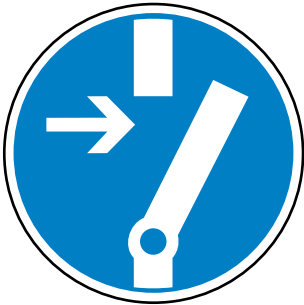
M14 Vor Arbeiten freischalten
